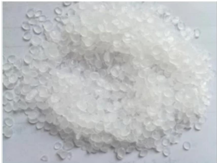
PVDF聚偏氟乙烯,外观为半透明或白色粉体或颗粒,分子链间排列紧密,又有较强的氢键,结晶度65%~78%,密度为1.17~1.79g/cm<sup>3</sup>,热变形温度112~145℃,长期使用温度为-40~150℃。PVDF不仅具有优良的耐化学腐蚀性、优良的耐高温色变性,耐氧化性,耐磨性、柔韧性、而且有很高的抗涨强度,耐冲击性强度,耐紫外线和高能辐射性。PVDF可用一般热塑性塑料加工方法加工,如热压、挤出、注射、传递模塑等成型工艺加工成各种复杂形状的制品和器件。广东锂电级聚偏氟乙烯常见问题这种选择性的溶解性可以用于锂电池的电极粘结剂。
